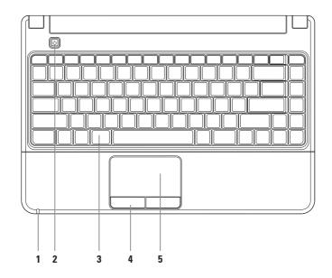
1 電源 / バッテリインジケータライト - このライトは、AC アダプタまたはバッテリの電源を使用しているときの次の状態を示します。
